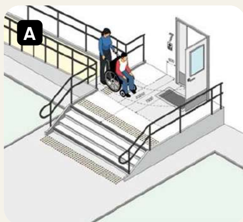
Рисунок 1.25. Варіанти влаштування пандуса для ґанків висотою до 75 см:
